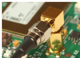
Antenne monteret via en vinkel adaptor
