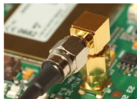
Antenne monteret via en vinkel adaptor
